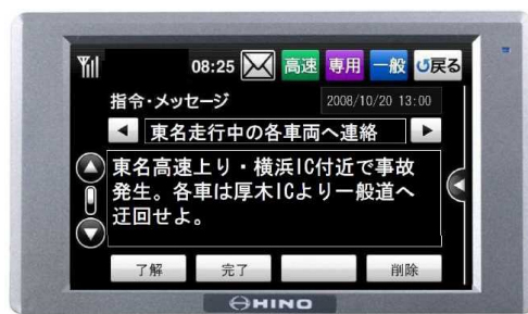
車載器(7インチタッチパネル) 表示例
