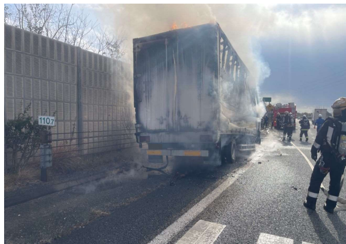
九州自動車道（福岡）での車両火災 原因：バーストのため停車後に出火
