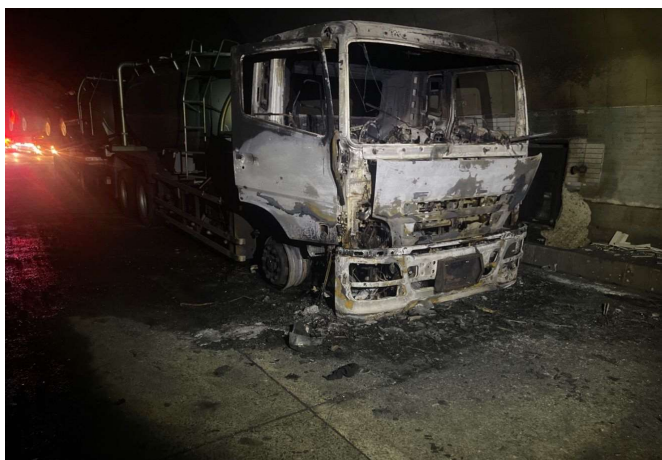
九州自動車道（熊本）トンネル内での車両火災 原因：不明、キャビネット後部より出火
